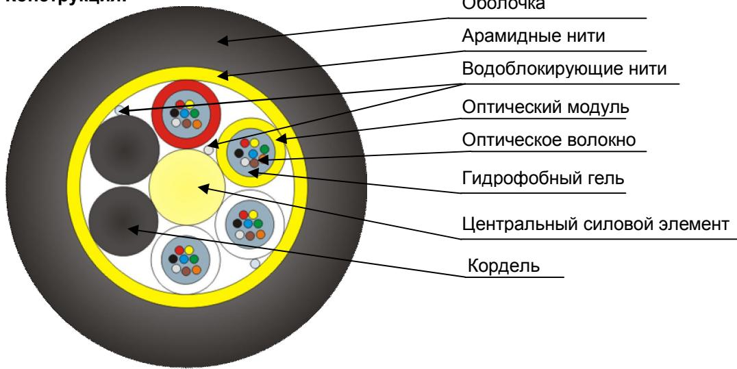
Кабель содержит сердечник модульной конструкции с центральным силовым элементом из диэлектрического стержня со спирально наложенной водоблокирующей нитью, вокруг которой скручены оптические модули со свободноложенными волокнами. Сердечник скреплен двумя обмоточными нитями с водоблокирующим свойством. На сердечник спирально накладываются арамидные нити и оболочка из полиэтилена средней плотности.
